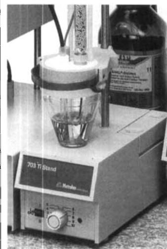
ter können die austrierte Probe und verbrauchtes Lösungsmittel abgesaugt und zur Entsorgung in eine Flasche transferiert werden. Ebenfalls mit dem Wippschalter läßt sich frisches Lösungsmittel dosieren oder kann das Titriergefäß gespült werden. Beim Spülenstand 703 von Metrohm das geeignete Gerät. Die ausgereifte Lösung vereinigt Rührer und Pumpe in einer kompakten Einheit. Durch Drücken auf den seitlich angebrachten Wippschal-
